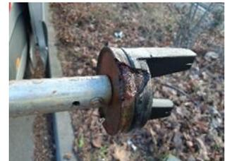
Die Instandsetzung von Überflurhydranten ist insbesondere auch in Löschwassernetzen sehr gefragt. Industriebetriebe haben oft mehrere hundert Überflurhydranten die im Bedarfsfall leicht und zuverlässig funktionieren müssen. Auch für Überflurhydranten haben wir viele Techniken entwickelt damit unsere Kunden Instandsetzungskosten bei hoher Funktionssicherheit senken können. (Bild defekte Innengarnitur)
