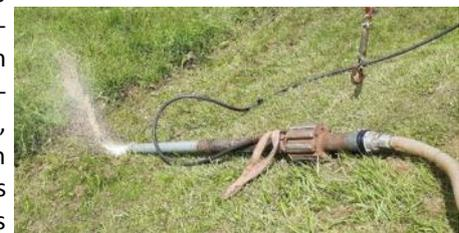
Abb. 3: Strahlsauger
