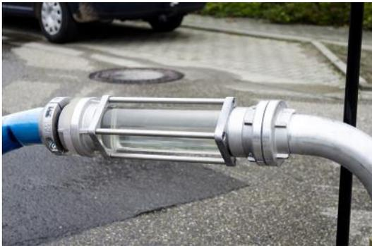
Abb. :Schauglas Storz B 450 mm am Standrohr
