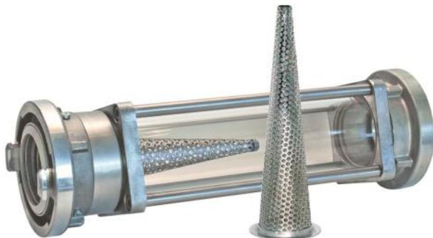
Zur Zurückhaltung von Sedimenten können die Schaugläser mit Kegelloch- oder Kegelfeinsieben ausgestattet werden. Diese sind mit einem Hakensprengring befestigt und können schnell ausgetauscht oder entfernt werden.
