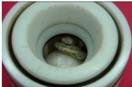
Steine blockieren den Rückflussverhinderer am Systemtrenner, ein Rückfluss wird trotzdem verhindert
